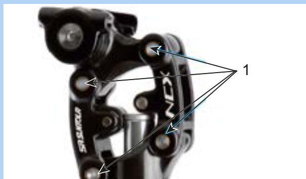
Figura 149: Punti di lubrificazione del cannotto reggisella ammortizzato SR Suntour
