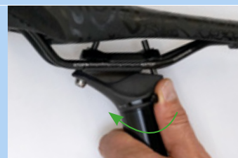
Figura 206: Chiusura della regolazione in altezza
