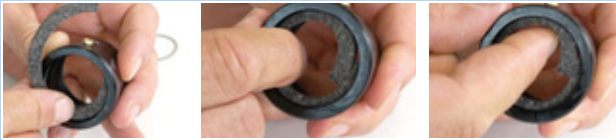
Figura 163: Applicazione dell'anello di feltro
