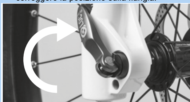
Figura 75: Chiusura del bloccaggio rapido
