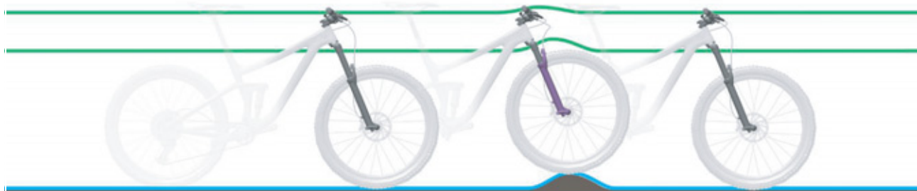
Figura 126: Comportamento di marcia ottimale su un terreno con asperità
