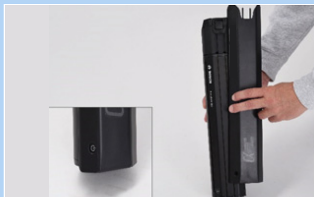
Figura 59: Applicazione della copertura della batteria sulla batteria
