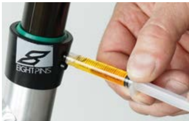
Figura 135: Lubrificazione del tubo del cannotto reggisella
