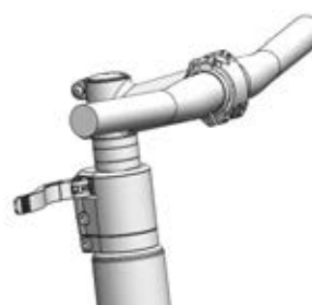
Figura 130: All Up con leva di serraggio dell'attacco manubrio aperta
