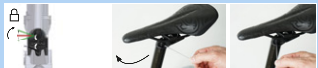
Figura 187: Chiusura della regolazione in altezza
