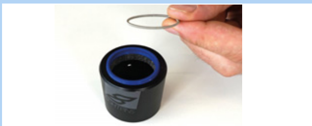
Figura 194: Anello elastico smontato
