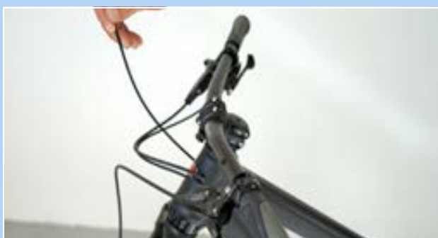
Figura 209: Aggancio del cappuccio terminale
