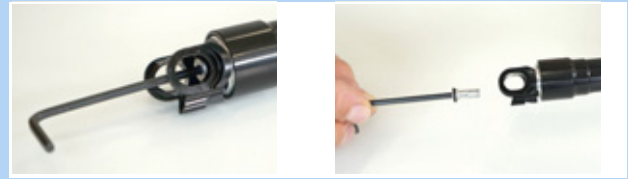
Figura 166: Svitamento del cappuccio della valvola
