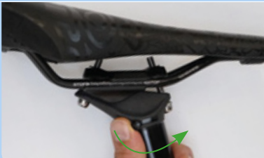
Figura 201: Apertura della regolazione in altezza
