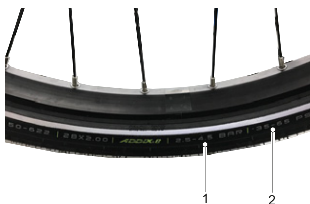
Figura 136: Pressione di gonfiaggio in bar (1) e in psi (2)
