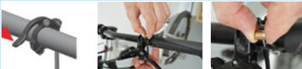
Figura 197: Smontaggio della cartuccia
