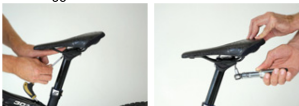
Figura 100: Serraggio della vite anteriore e posteriore
