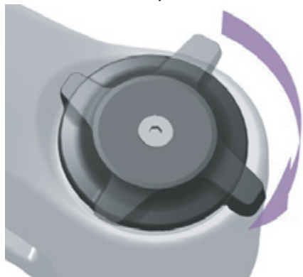
Figura 171: Regolazione più rigida del regolatore dello stadio di compressione
