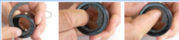
Figura 208: Applicazione dell'anello di feltro
