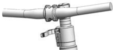
Figura 156: Esempio: All Up con leva di serraggio dell'attacco manubrio aperta
