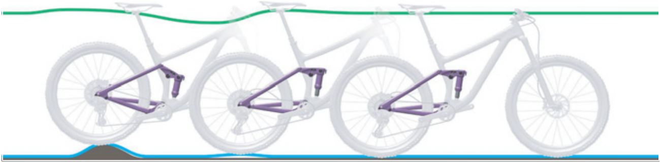
Figura 281: Corsa di estensione troppo veloce dell'ammortizzatore del carro posteriore
