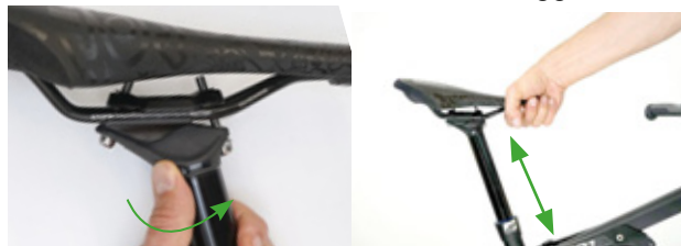
Figura 95: Regolazione dell'altezza del canotto reggisella
