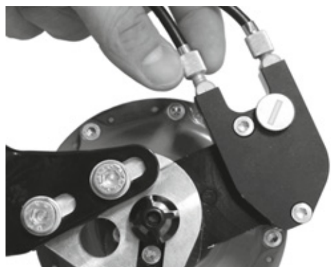
Figura 188: Le versioni del mozzo Rohloff con comando esterno del cambio hanno i regolatori del tensionamento sulla scatola dei cavi situata sul lato sinistro
