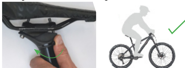
Figura 96: Serraggio dell'asse del canotto reggisella
