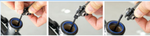
Figura 236: Rimozione del cavo meccanico
