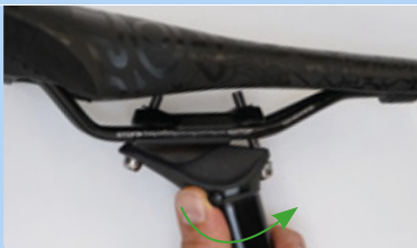
Figura 246: Apertura della regolazione in altezza
