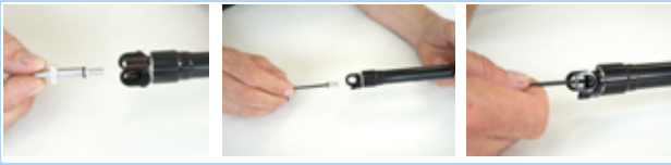
Figura 214: Fissaggio del coperchio della valvola della cartuccia
