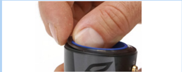
Figura 238: Estrazione dell'anello a labbro di tenuta
