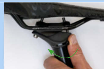
Figura 251: Chiusura della regolazione in altezza
