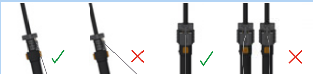
Figura 222: Cavo meccanico corretto ed errato
