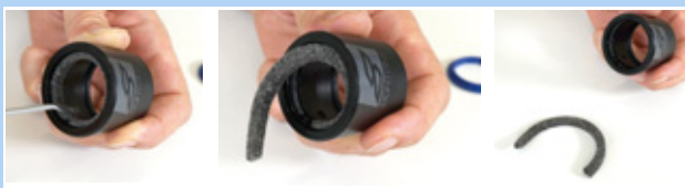
Figura 241: Rimozione dell'anello di feltro
