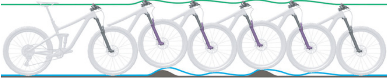
Figura 257: Corsa di estensione troppo veloce della forcella ammortizzata
