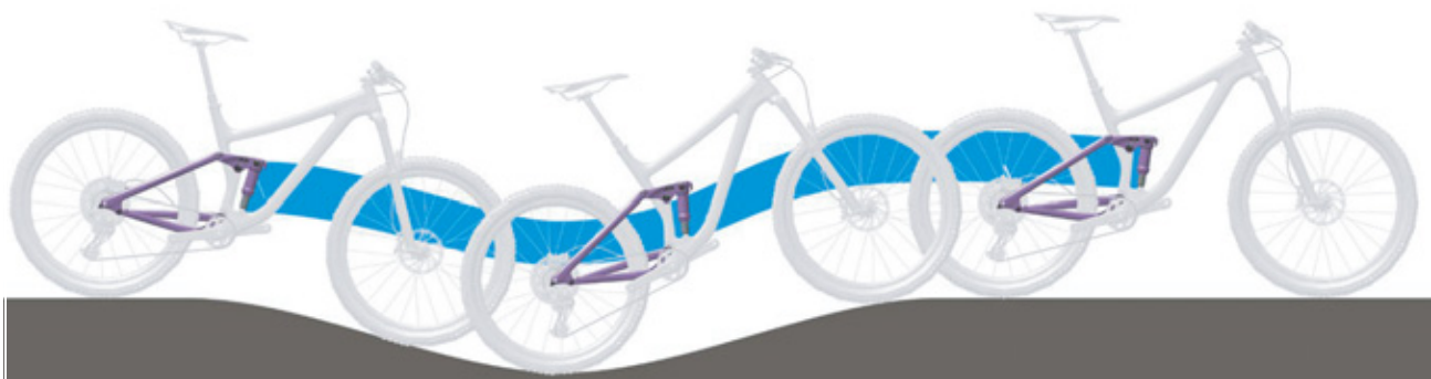
Figura 17: Comportamento di marcia ottimale dell'ammortizzatore del carro posteriore su un terreno con dossi
