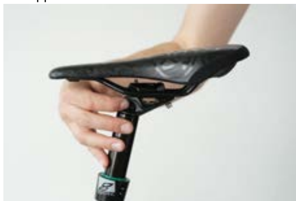
Figura 102: Regolazione dell'inclinazione della sella mediante la manopola di regolazione
