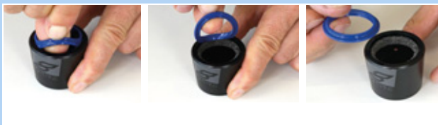
Figura 240: Estrazione del parapolvere
