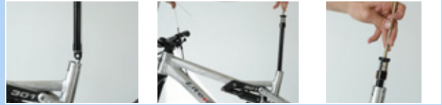
Figura 223: Fissaggio del coperchio della valvola della cartuccia
