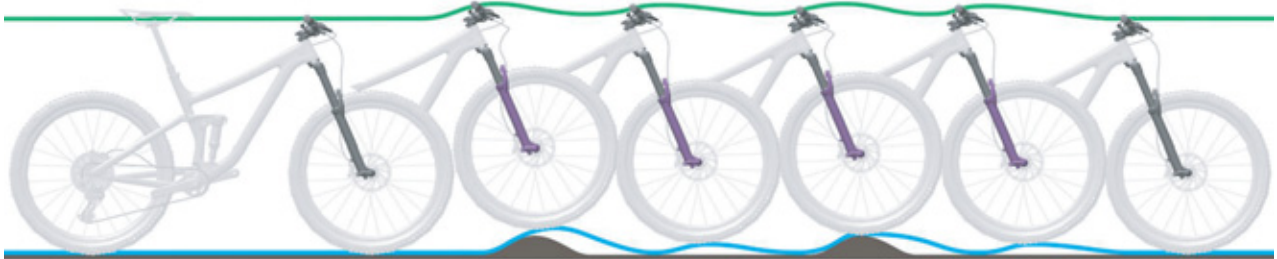
Figura 265: Corsa di estensione troppo veloce della forcella ammortizzata
