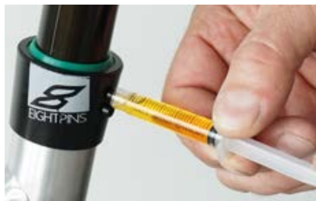
Figura 180: Lubrificazione del tubo del cannotto reggisella
