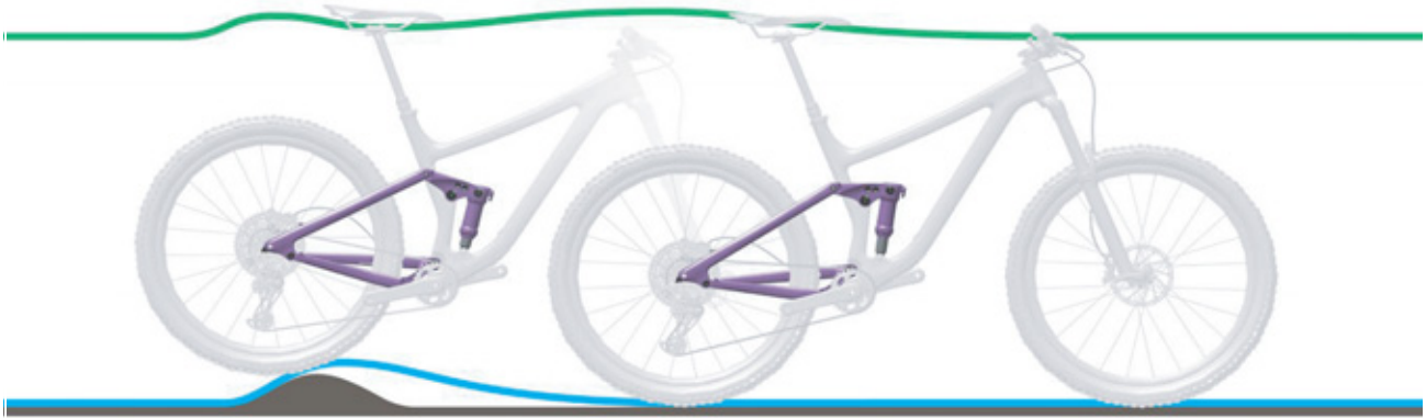
Figura 279: Smorzamento troppo duro dell'ammortizzatore del carro posteriore su asperità
