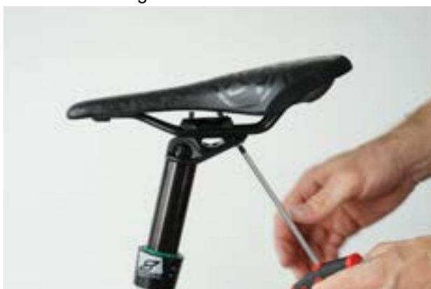
Figura 105: Allentamento della vite posteriore
