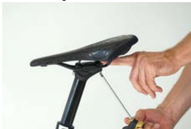
Figura 99: Allentamento della vite posteriore
