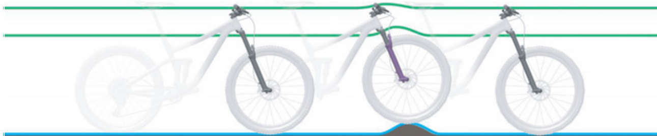
Figura 169: Comportamento di marcia ottimale su un terreno con asperità
