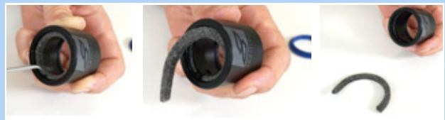
Figura 206: Rimozione dell'anello di feltro
