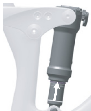
Figura 139: Spostamento dell'O-ring sull'ammortizzatore del carro posteriore
