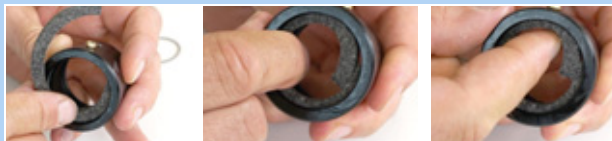
Figura 243: Applicazione dell'anello di feltro
