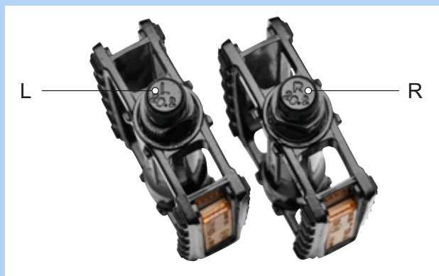
Figura 84: Esempio: identificazione dei pedali
