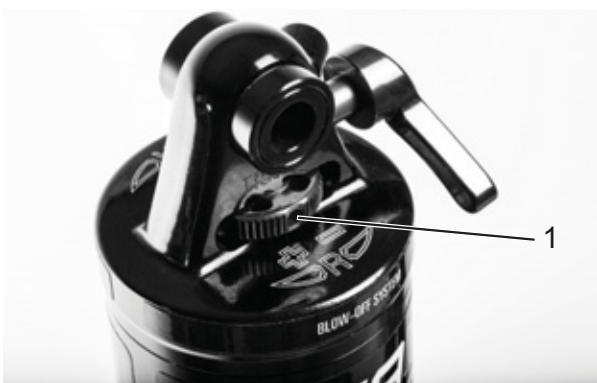
Figura 276: Regolatore del rebound Suntour (1) sull'ammortizzatore del carro posteriore
