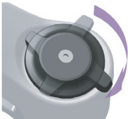
Figura 270: Regolazione più rigida del regolatore dello stadio di compressione
