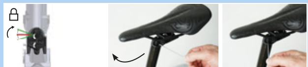
Figura 232: Chiusura della regolazione in altezza
