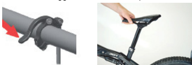
Figura 94: Estrazione della molla pneumatica a gas idraulica
