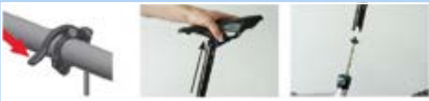
Figura 196: Estrazione del cannotto reggisella
