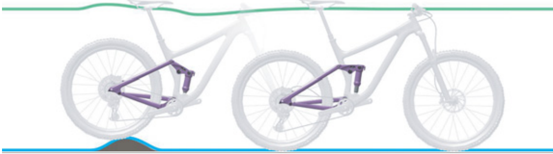
Figura 18: Comportamento di marcia ottimale dell'ammortizzatore del carro posteriore su asperità
