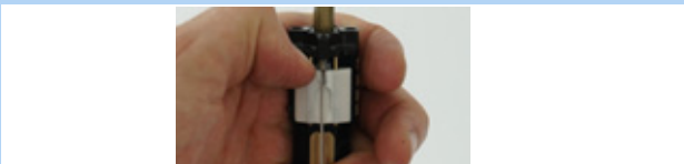
Figura 221: Spinta del cursore di azionamento bianco verso il basso
