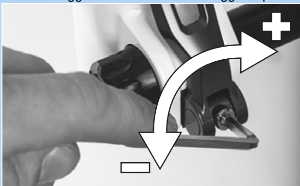
Figura 193: Regolazione della forza di serraggio del bloccaggio rapido
