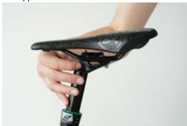
Figura 106: Regolazione dell'inclinazione della sella mediante la manopola di regolazione
