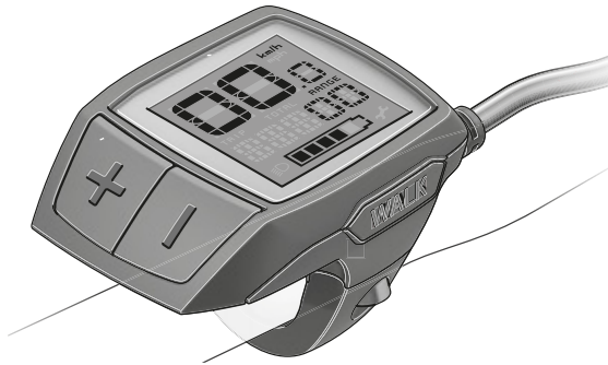
Figura 43: Computer di bordo BOSCH Purion
