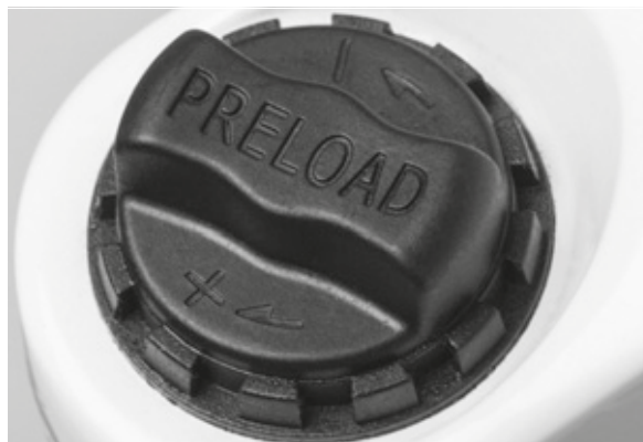
Afbeelding 29: Afstelwiel voor de negatieve veerweg op de kroon van de verende voorvork
