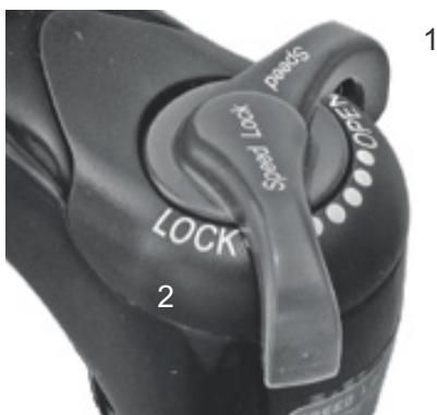
Afbeelding 36: Suntour drukdemperafsteller met de standen OPEN (1) en LOCK (2)
