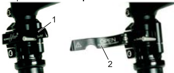
Afbeelding 27: Gesloten (1) en geopende (2) voorbouwspanhendel, voorbeeld by.schulz speedlifter
