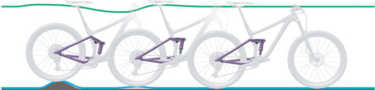
107. ábra: A hátsó lengéscsillapító túl gyors kirugózása
