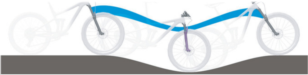
103. ábra: A teleszkópos villa túl puha rugózása hegymenetben
