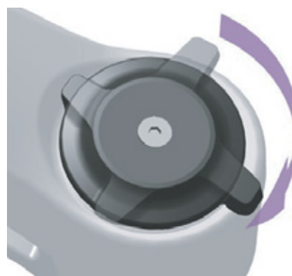
89. ábra: A nyomásfokozat-beállító keményebb beállítása
