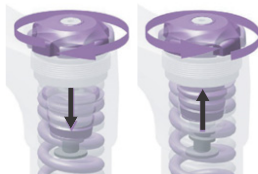
52. ábra: Előfeszítés-beállítógyűrű befelé és kifelé forgatása.
