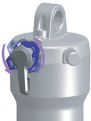
66. ábra: A nyomásfokozat-beállító puhább beállítása
