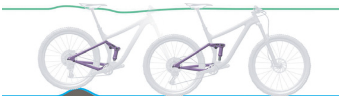
12. ábra: A hátsó lengéscsillapító optimális menetviselkedése egyenetlenségeknél
