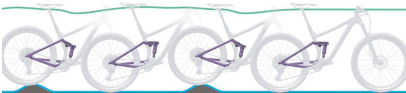
59. ábra: A hátsó lengéscsillapító optimális menetviselkedése
