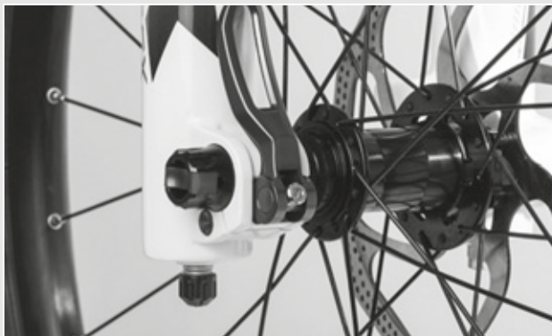
94. ábra: A gyorsár szorítóerejének beállítása
