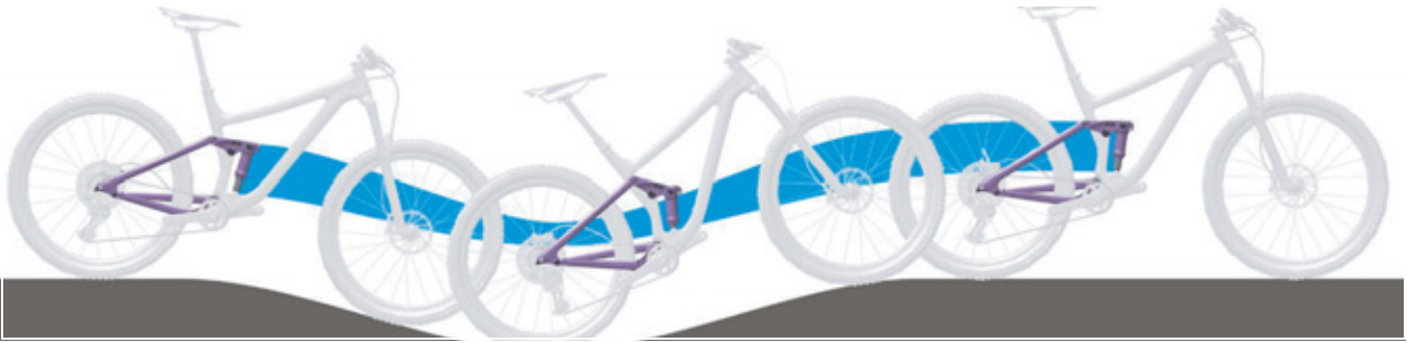
111. ábra: A hátsó lengéscsillapító túl puha rugózása hegymenetben
