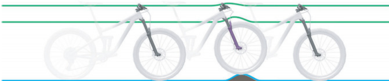
7. ábra: A villa optimális menetviselkedése egyenetlenségek esetén
