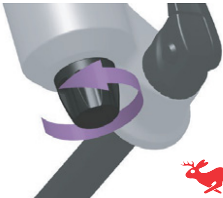
102. ábra: A húzófokozatos lengéscsillapító fordítása a nyúl irányába
