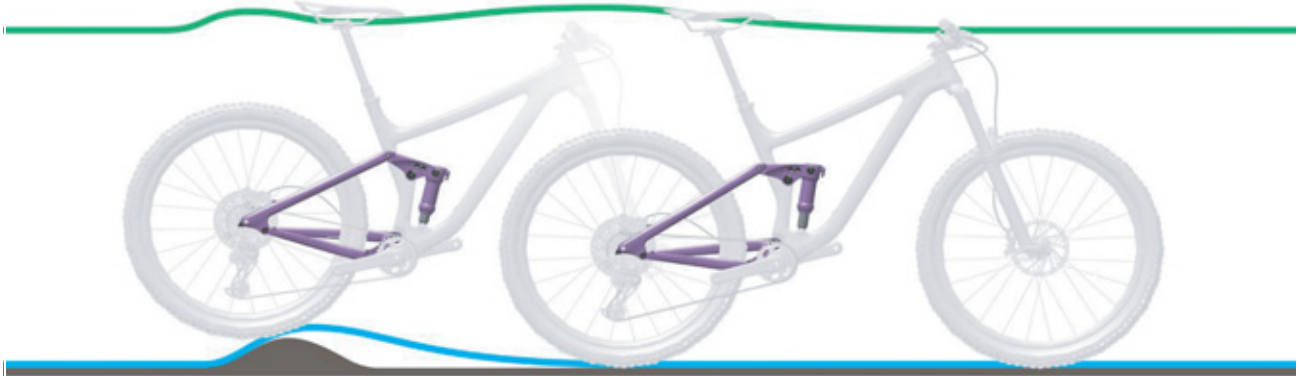
113. ábra: A hátsó lengéscsillapító túl kemény csillapítása egyenetlenségeknél
