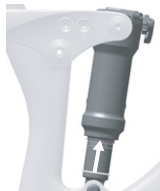
57. ábra: O-gyűrű eltolása a hátsó lengéscsillapítón
