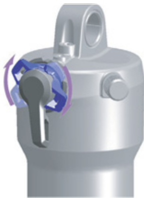
112. ábra: A nyomásfokozat-beállító keményebb beállítása
