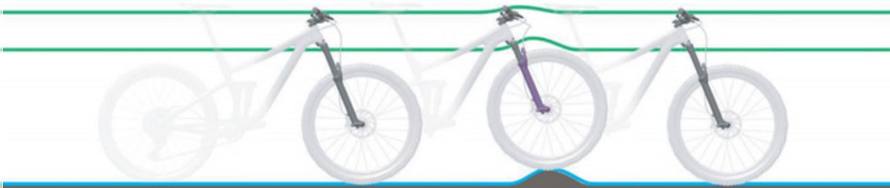
87. ábra: Optimális menetviselkedés egyenetlenségek esetén
