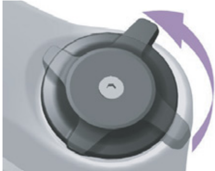
90. ábra: A nyomásfokozat-beállító puhább beállítása
