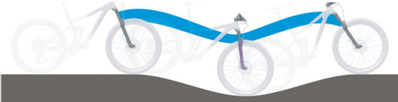
86. ábra: Optimális menetviselkedés dombos terepen
