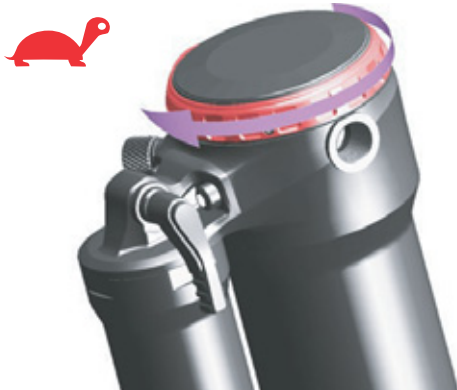
108. ábra: A húzófokozatos lengéscsillapító fordítása a teknős irányába
