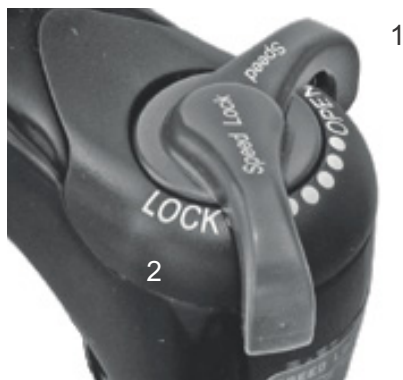
Paveikslėlis 87: „Suntour“ slėgio pakopų nustatymo reguliatorius su padėtimis OPEN (1) ir LOCK (2)
