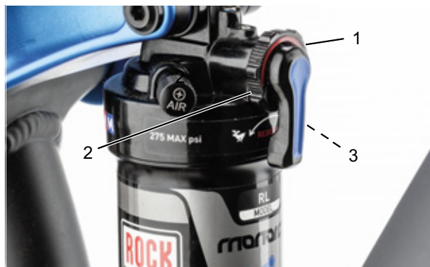
Paveikslėlis 88: Atšokimo amortizatoriaus nustatymas galinio amortizatoriaus nustatymo ratuku (1)
