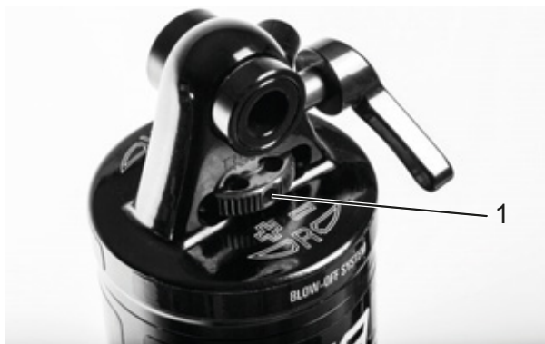
Paveikslėlis 74: „Suntour“ atšokimo pakopos reguliatoriaus ratas (1) ant galinio amortizatoriaus
