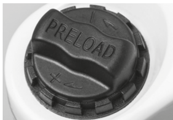
Paveikslėlis 70: Neigiamos amortizatorių eigos nustatymo ratukas ant amortizuojančių šakių karūnėlės
