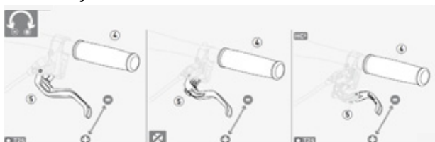
Paveikslėlis 68: „Magura“ diskinių stabdžių svirties atstumo iki vairo rankenos nustatymas
